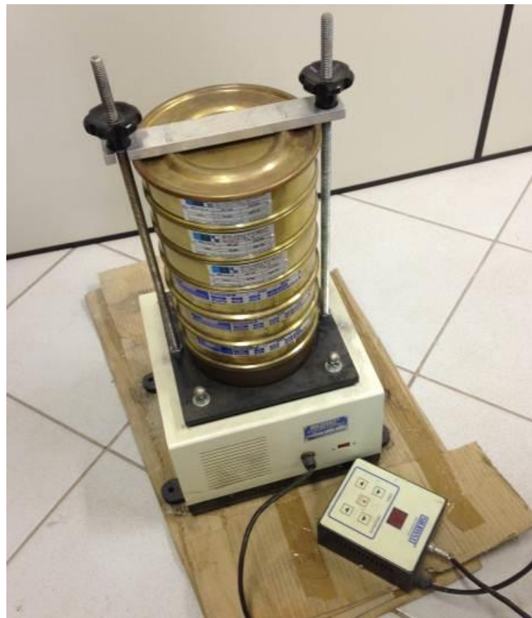
Figura 4 – Agitação do conjunto de peneiras com agregados de solo coletado.
