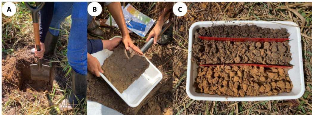
Figura 2 - Realização do Diagnóstico Rápido da Estrutura do Solo (DRES): A) Abertura da mini trincheira; B) Acomodando o bloco de solo cuidadosamente da bandeja C) avaliação das estruturas na bandeja.
