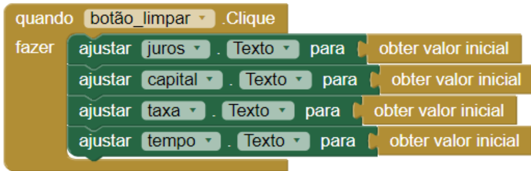
Figura 6 – Blocos de programação do botão limpar.
