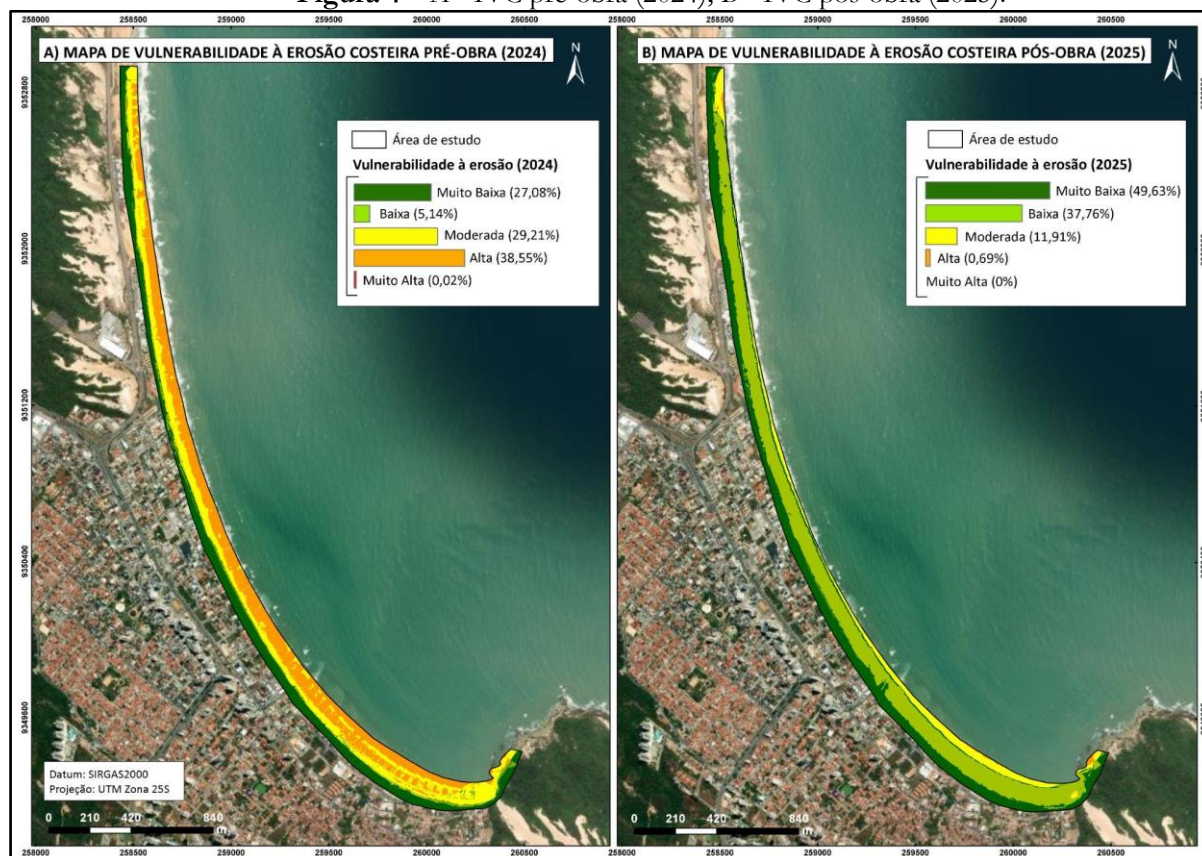
Figura 4 – A - IVC pré-obra (2024); B - IVC pós-obra (2025).
