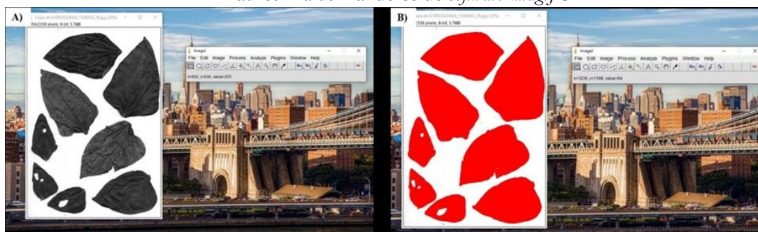
Figura 1 - Medições de comprimento, largura e área de folíolos da variedade crioula de feijão-caupi Paulistinha utilizando-se do software ImageJ ®.
