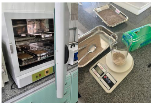
Figura 4 - Secagem (a) e pesagem (b) das amostras, respectivamente.
