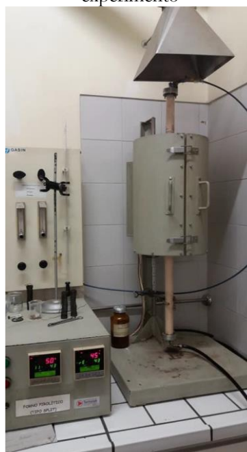
Figura 2 – Forno pirólítico tubular vertical de leito fixo utilizado no processo de pirólise deste experimento
